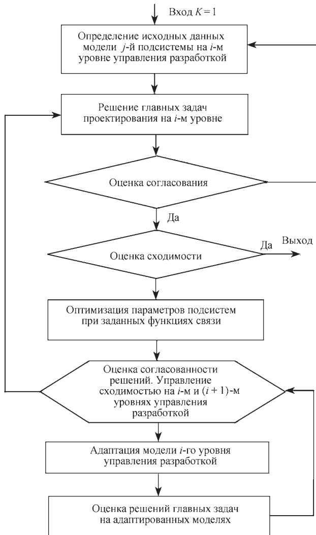
Рис. 6.7.1. Алгоритм комплексного согласованного оптимизационного поиска КТР при двухуровневом управлении разработкой
