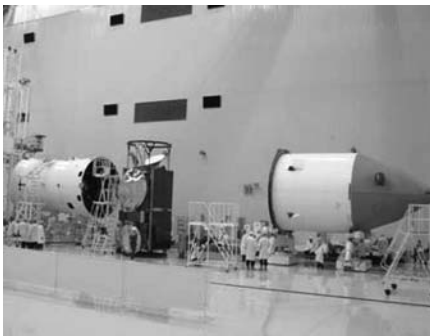
Рис. 7.2.9. Подготовка автоматического КА и РБ к сборке КГЧ на рабочем месте ТК КГЧ
