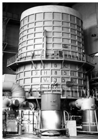
Рис. 7.2.5. Термовакуумная установка для проведения термовакуумных и температурных испытаний изделий РКТ
