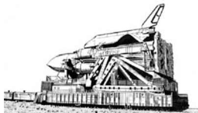
Рис. 8.1.19. Транспортно-установочный агрегат с МТКС «Энергия»—«Буран»
