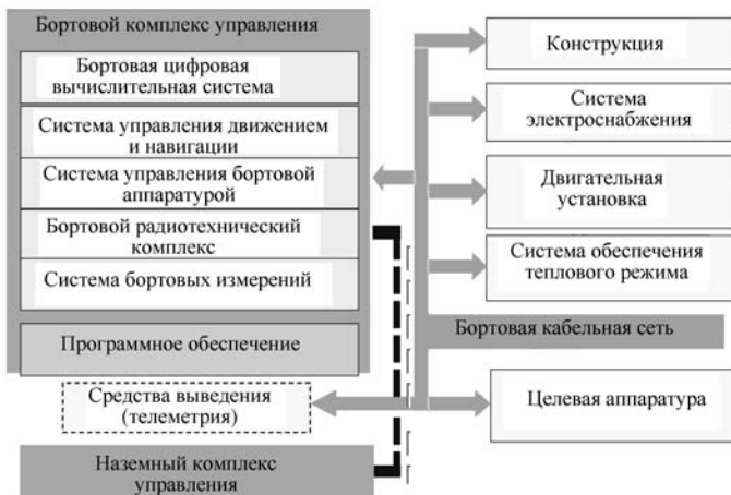
Рис. 4.1.1. Бортовой комплекс управления автоматического КА
