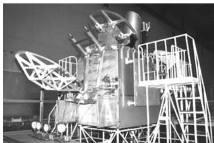
Рис. 7.2.1. Натурная модель проектно-конструкторского макета автоматического КА системы спутниковой связи
