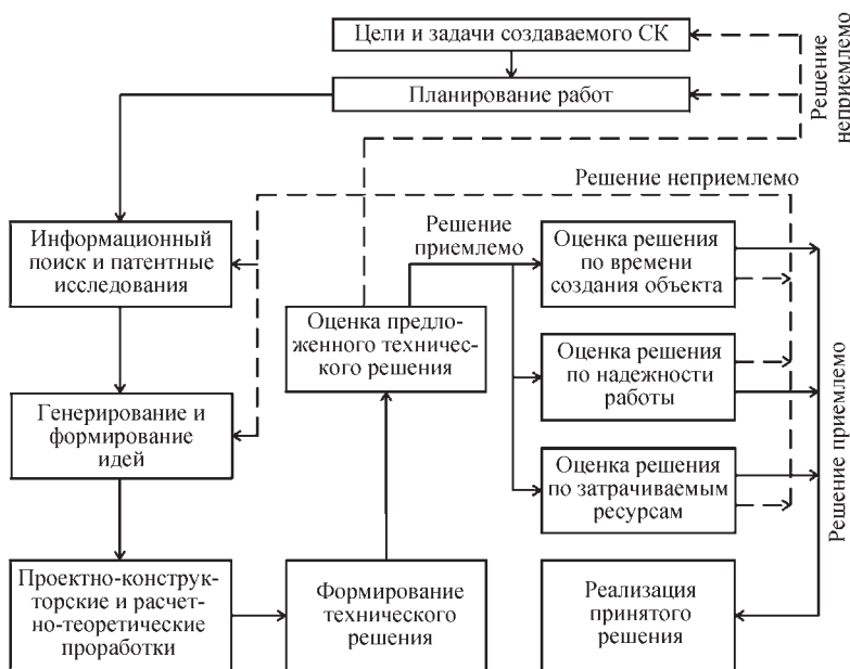
Рис. 8.1.1. Схема процесса принятия проектно-конструкторского решения на этапе разработки технического предложения
