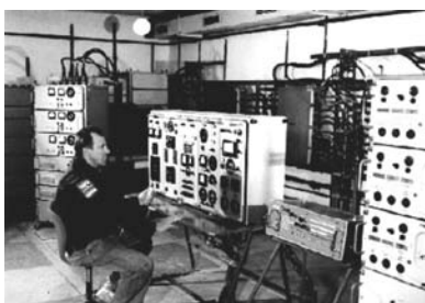
Рис. 8.4.6. Подготовка к штатной работе системы наземного проверочно-пускового оборудования РН
