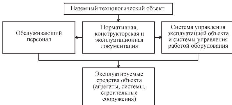
Рис. 8.4.2. Структурная схема эксплуатации наземного технологического объекта
