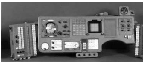
Рис. 4.4.93. Система отображения информации третьего поколения. СОИ корабля «Союз-7К»
