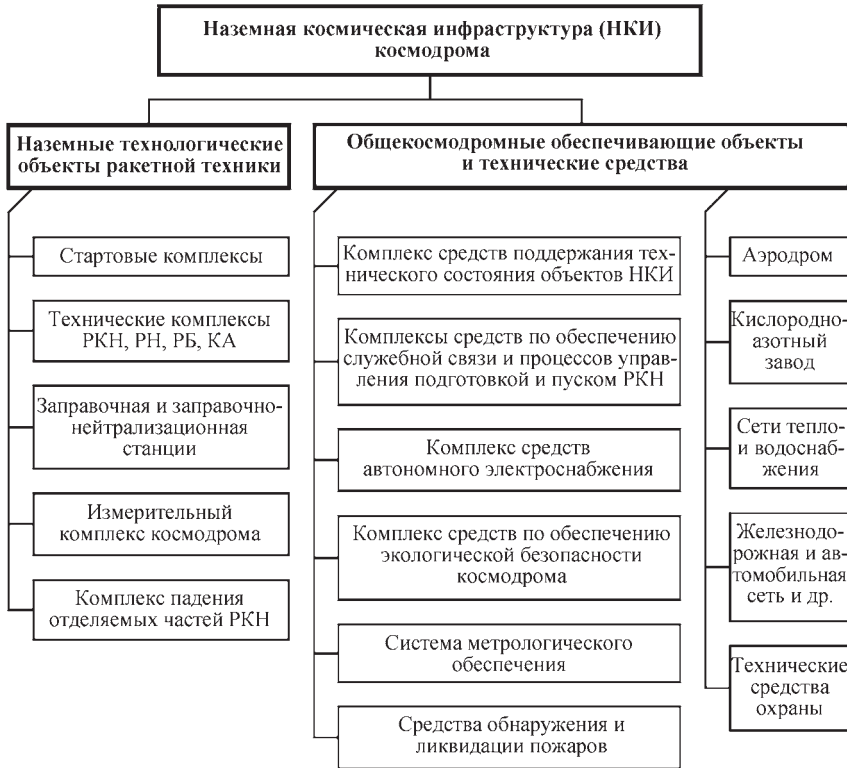
Рис. 8.6.1. Типовой укрупненный состав объектов и средств наземной космической инфраструктуры космодрома
