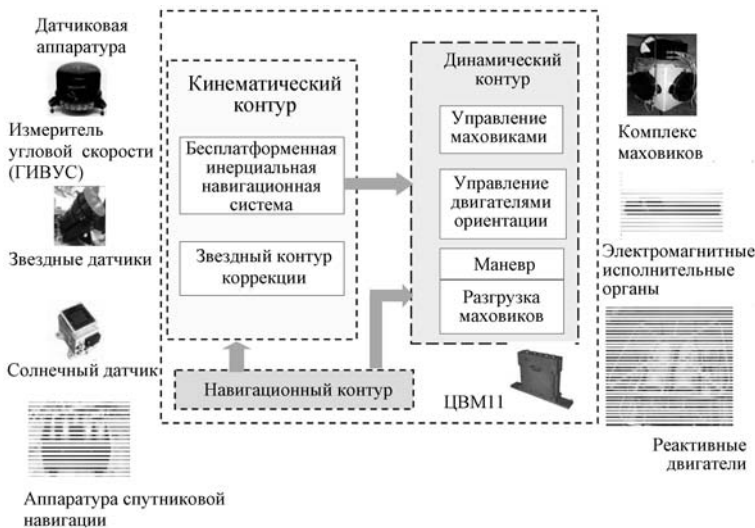
Рис. 4.1.3. Система управления движением и навигации автоматического КА
