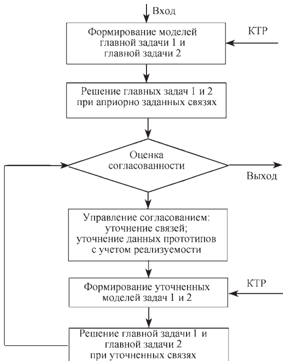
Рис. 6.7.3. Укрупненный алгоритм согласованной оптимизации параметров модификации ЛА и процесса обеспечения надежности
