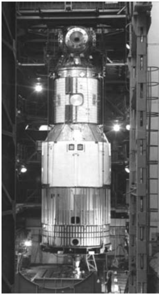
Рис. 7.3.4. Вибропрочностные испытания рабочего отсека служебного модуля (СМ) Международной космической станции (МКС)
