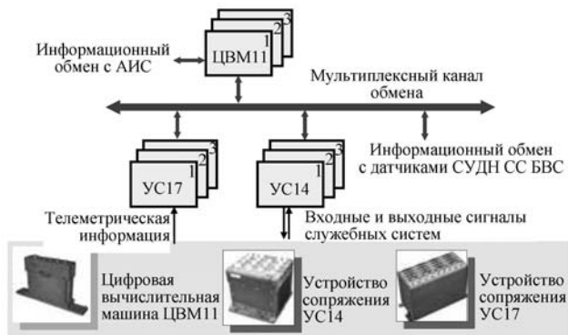
Рис. 4.1.2. Структура бортовой цифровой вычислительной системы
