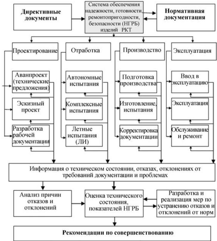
Рис. 7.1.1. Структура и субъекты системы обеспечения надежности РКТ
