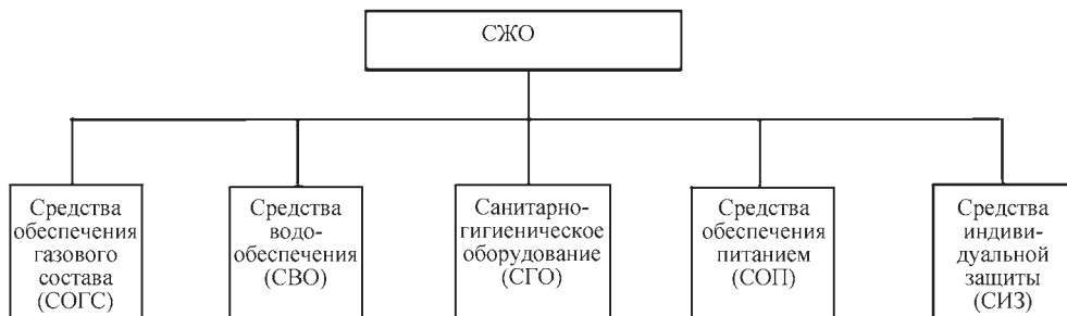
Рис. 5.2.2. Структурная схема СЖО КА
