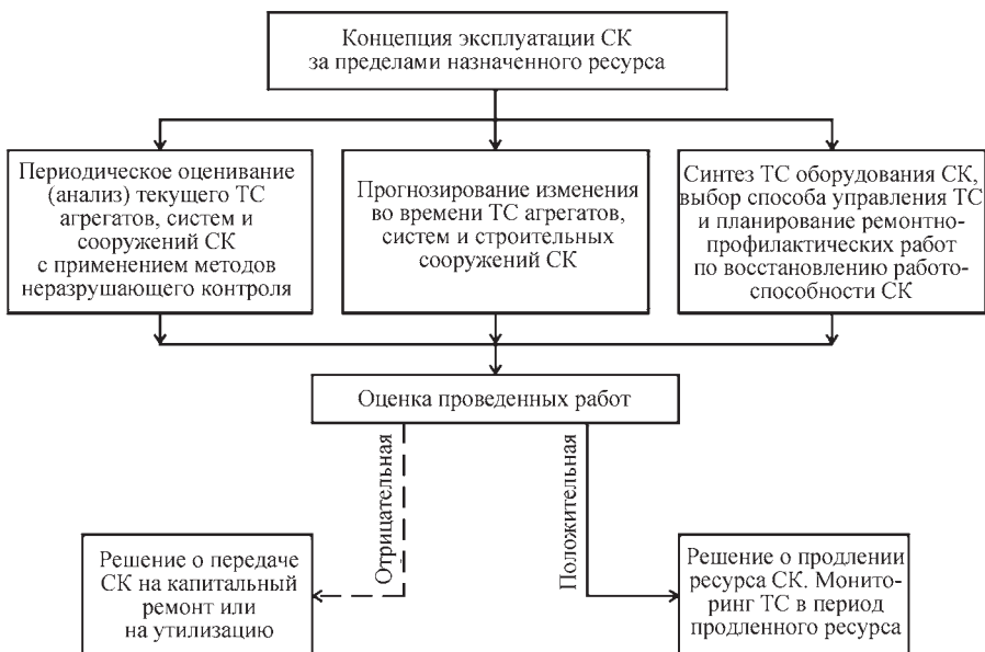
Рис. 8.4.4. Концепция эксплуатации СК за пределами назначенного ресурса
