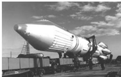
Рис. 8.4.9. Подача транспортно-установочной тележки с РКН на установщик
