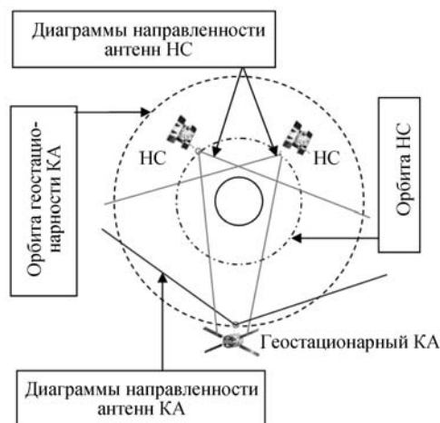
Рис. 4.4.7. Схема работы геостационарного КА по «обратным» НС
