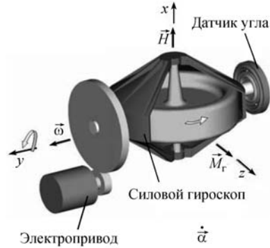
Рис. 4.4.80. Кинематическая схема гиродина:
