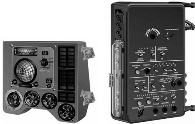
Рис. 4.4.92. Первое поколение системы отображения информации. Пульт и приборная доска корабля «Восток»
