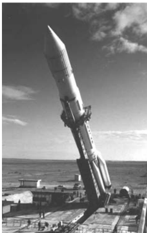
Рис. 8.4.10. Подъем установщиком транспортно-установочной тележки с ракетой в вертикальное положение
