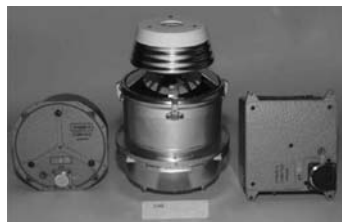
Рис. 4.4.41. Планетный оптический датчик с механическим сканированием для высот 180...500 км
