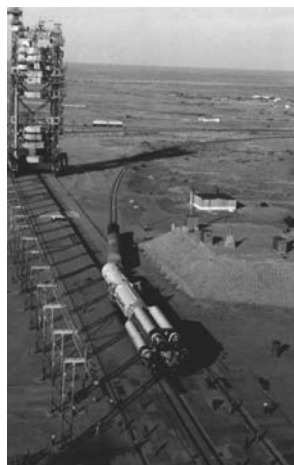
Рис. 8.4.8. Транспортирование РКН «Протон-К» на СК
