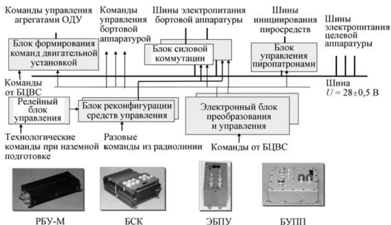
Рис. 4.1.4 Система управления бортовой аппаратурой автоматического КА
