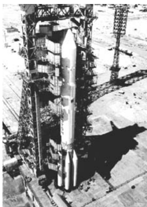
Рис. 8.4.11. РКН «Протон» на пусковом устройстве стартового сооружения перед подготовкой ее к пуску
