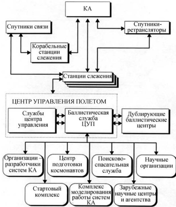
Рис. 9.4.3. Схема информационных обменов при оперативном БНО
