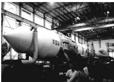
Рис. 8.4.7. РН «Протон-К» с КА на транспортно-установочной тележке в МИК перед вывозом на СК
