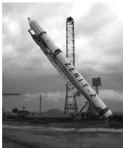
Рис. 8.1.17. Подъем РКН «Зенит» на СК в вертикальное положение
