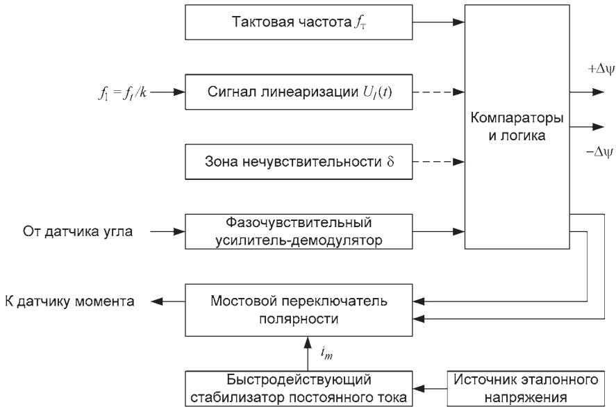
Рис. 4.4.30. Схема электронной части дискретного контура обратной связи
