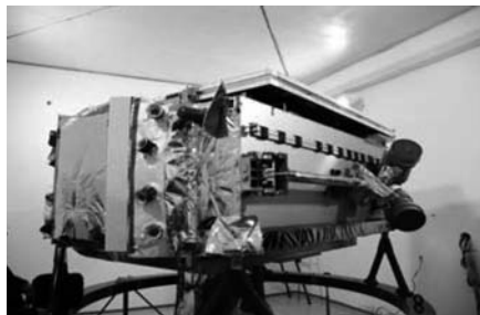
Рис. 7.2.4. Натурная модель динамического макета автоматического КА дистанционного зондирования Земли в акустической камере
